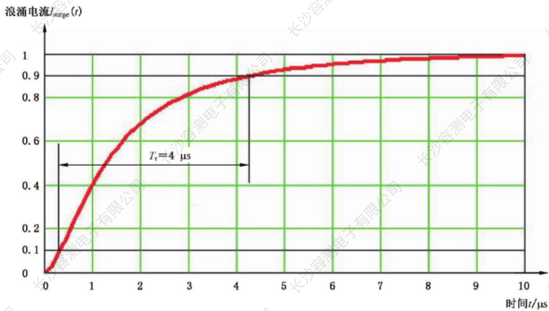
图 E.11 浪涌电流(5/320 μs): 上升时间 T_r
